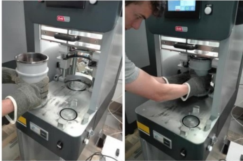
3.5.2.10. 将试模推入工作舱，关闭舱门。
