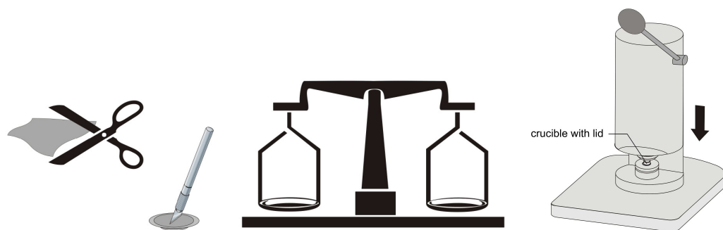
制样 → 坩埚盖扎孔 → 样品称量 → 坩埚密封
