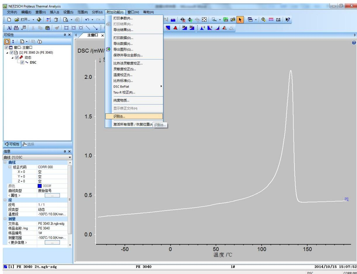
点击后即可进入自动识别的结果界面, 如下图所示, 图中箭头所指的部分分别为单条曲线相似度结果、分类曲线相似度结果以及所用数据库。相似度结果中, 后缀为 DSC 的为数据库曲线数据, 后缀
